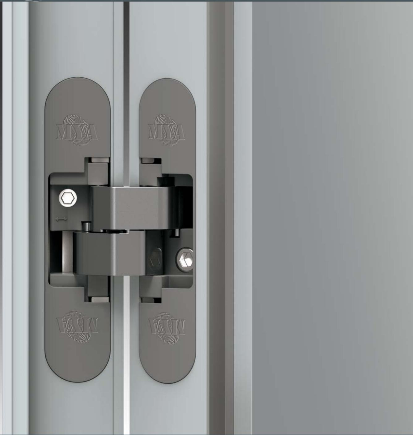
Cerniere a scomparsa registrabili sui 3 assi, testate a 200.000 cicli di apertura, dotate di speciali guide in nylon che non richiedono l'uso di lubrificanti. La registrazione è semplice ed intuitiva, basta togliere la cover per accedere ai registri che permettono la regolazione millimetrica dell'anta.
