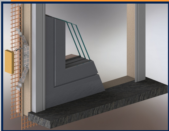
Dettagli di posa (ESTERNO)
