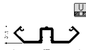
TMZ25067 Pressore 133mm angolo pre-forato x=300 mm
